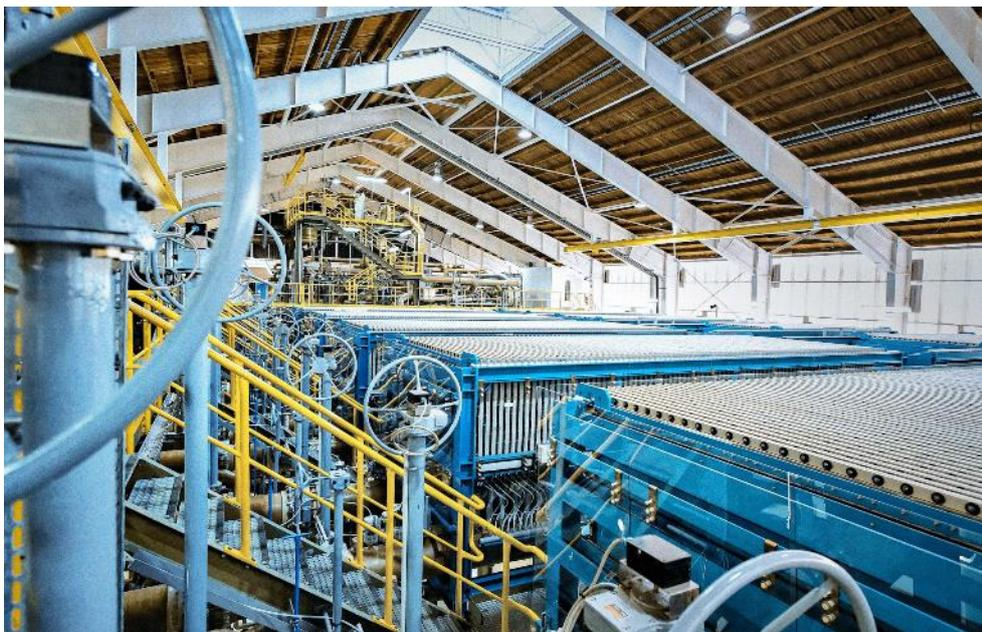
Elektrolyseanlage zur Erzeugung von grünem Wasserstoff
